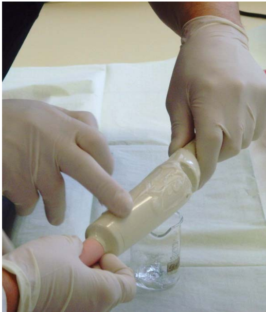
Kontamination mit Ultraschall- Gel mit 10^6 KBE Geobacillus stearothermophilus
